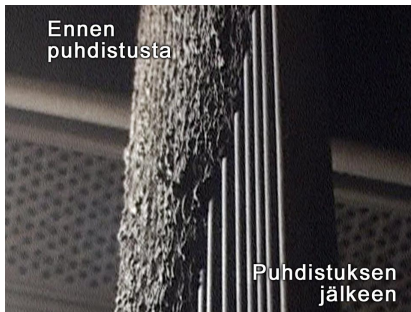
Puhalluspuhdistuksia: kattilan lämmönsiirtopinnat ja turbiinin siivet
